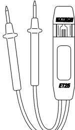
**Prises et cordons mis à la terre AC à 3 fils :** Insérez les sondes dans les fentes sous tension (étroite) et neutre (large) de la prise. Le testeur s'illumine en contact avec un circuit sous tension. Pour contrôler la mise à la terre, insérez une sonde dans le côté sous tension (étroit) et l'autre dans la terre en forme de « U ». Le testeur devrait s'illuminer.
